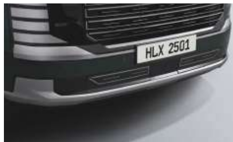
Серебристая защитная накладка на передний бампер и активные воздушные заслонки
